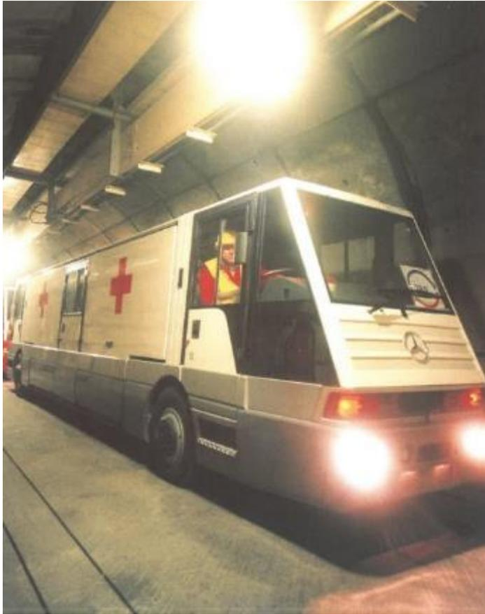
*Der Versorgungstunnel ermöglicht u.a. Wartungs- und Rettungsfahrzeugen den Zugang zum Tunnel.
